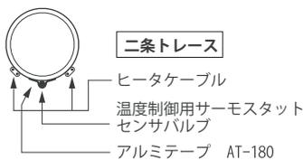
4. 左図のように配管下半分4/5度の位置にセンサーバルブを取付けてください。バルブを取付ける際には配管サポート、バルブ、その他ヒートシンクとなるものから少なくとも約0.9m (3ft) 以上距離をおいてください。また、キャピラリにはキック部分や半径15mmより小さい曲げ部分を持たせないよう注意してください。
